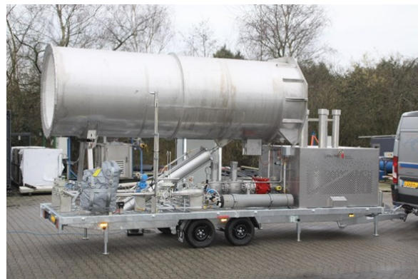
Mobiele fakkel E-HT-M-500 in trailer uitvoering
