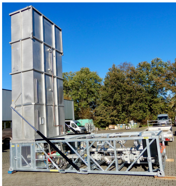
Mobiele fakkel E-HT-M-1.200 skid uitvoering t.b.v. transport op vrachtwagen (evt. met eigen laad- en loskraan)
